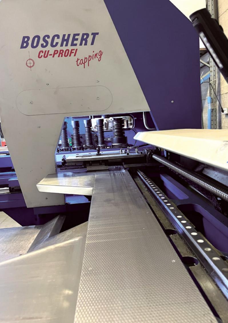
ogni lato, ottenendo pezzi piatti e rettilinei, quasi senza scarti. È, infatti, importante che le barre siano bloccate sia davanti che dietro la testa del punzone per evitare torsioni e piegature del materiale. I pezzi finiti vengono scaricati tramite il meccanismo di avanzamento. Schermo a colori TFT da 10,5", ergonomico e regolabile e il software grafico e conversazionale garantiscono una programmazione semplice e veloce.
